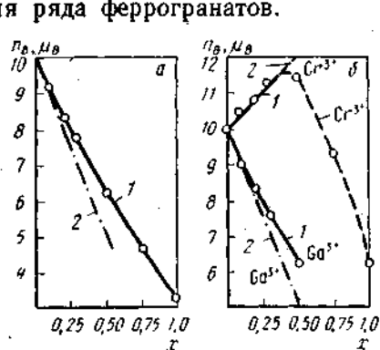
Рис. 26. Зависимость n_B феррогранатов иттрия (\text{Me}_2\text{O}_3)_x \cdot 3\text{Y}_2\text{O}_3 \cdot (\text{Fe}_2\text{O}_3)_{5-x} (при 0 К) от содержания ионов \text{Al}^{3+} (а), \text{Ga}^{3+} и \text{Cr}^{3+} (б); 1 — экспериментальные кривые; 2 — теоретические кривые, полученные в предположении, что ионы \text{Al}^{3+} и \text{Ga}^{3+} занимают исключительно d -положения, а ионы \text{Cr}^{3+} — a -положения
