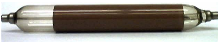
Рис. 3.11. Самогаснущий лічильник Гейгера-Мюллера
