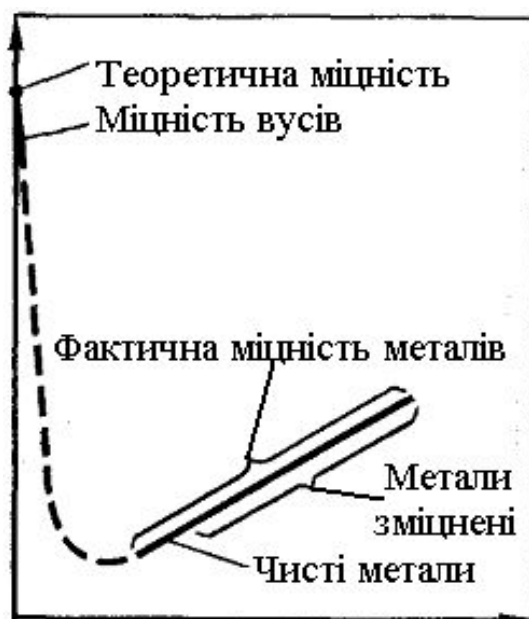
Рис. 7.9. Вплив дефектів кристалічних ґраток на міцність кристала [2]
