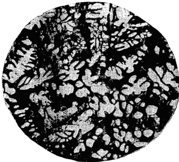
Рис. 18.22. Мікроструктура литого сплаву з 96% Zn, 4% Al [25]: дендрити \beta - фази (світлі); \alpha_2 — фаза, що частково розпалась (темний)
