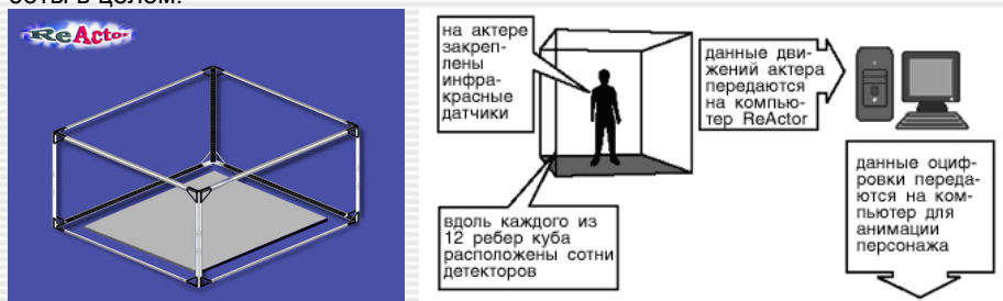
Рис.5.7. Устройство Ascension ReActor2. Недорогая система оцифровки движения для одного спортсмена. Оборудована электронными камерами вдоль каждого из ребер куба. Полный охват рабочего пространства и быстрая установка.
