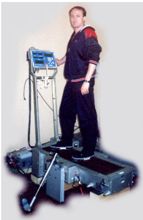
Рис.6.1. Автор настоящего учебно-методического пособия на беговой дорожке, установленной в российском сегменте «Звезда» международной космической станции «Альфа». Компьютер беговой дорожки считывает информацию со специальных электронных чипов, подбирая для каждого астронавта индивидуальную нагрузку.
