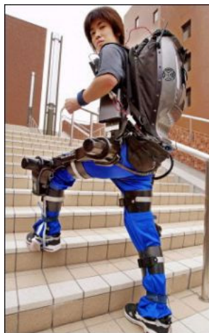
Рис.5.16. Экоскелет HAL-3 Йошиюки Санкай (концерн Mitsui & Co, Япония) помогает инвалиду перемещаться со скоростью до 4 км/ч
