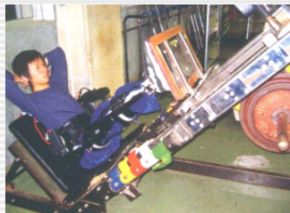
Рис.5.17. HAL в тренажерном зале Обратите внимание на спокойное выражение лица человека, изображенного на фото справа: специально подогнанный моторизованный HAL-3 позволяет этому инженеру из Цукубы без труда поднимать ногами груз до 180 кг.
