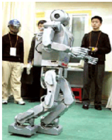
Рис.5.14. Мастеру тайцзи-цюань необходима гибкость, и BHR-1 ею обладает: его конструкция насчитывает 32 сочленения. Рост китайского первенца 158 см, вес 76 кг - вполне традиционные параметры для среднего жителя Поднебесной.
