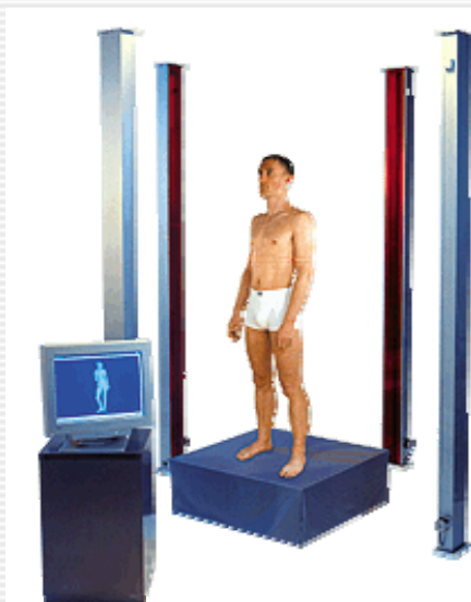
Рис.5.6. Одна из современных 3D-установок, VITUS 3D Body Scanner (Германия) позволяющих проводить антропометрические замеры тела спортсмена не более чем за 20 секунд.
