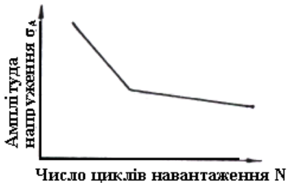
Рисунок 9.6 - Схематичне зображення кривої Велера для кородованого зразка
