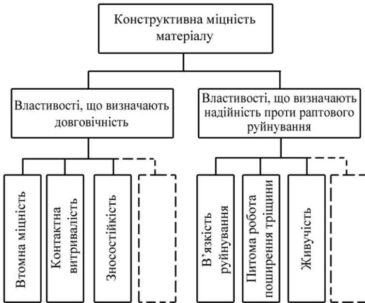
Рисунок 10.1 - Класифікація критеріїв, використовуваних для оцінки конструктивної міцності сталі
