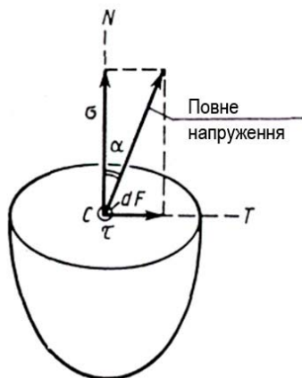
Рисунок 3.2 – Схема розкладання напруження на дотичну і нормальну складові
