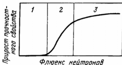
Рис. 13.36. Обобщенный вид зависимости изменения прочностных свойств ГЦК металлов от флюенса нейтронов
