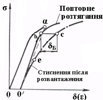
Рисунок 5.5 – Схема ефекту Баушингера
