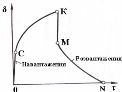
Рисунок 5.6 – Схема пружного результату післядії
