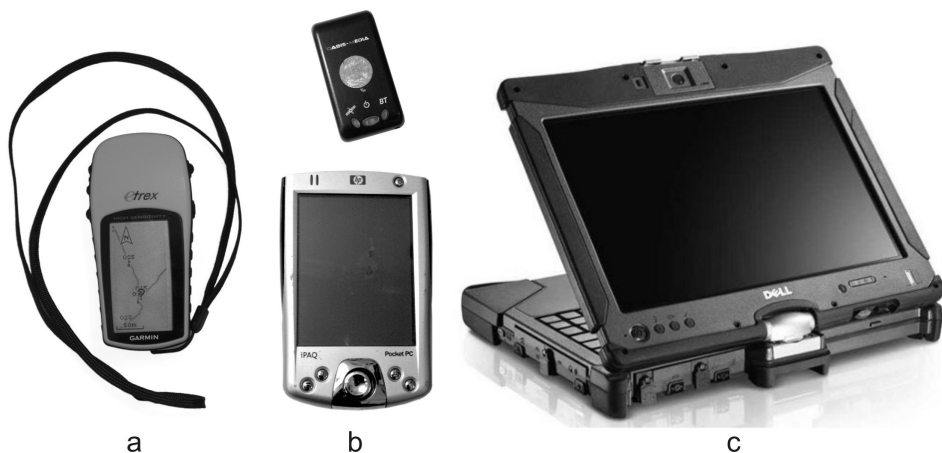
Рис. 1. Прилади, що використовувались при польових дослідженнях (а – GPS-навігатор, б – КПК з антеною, с – планшетний комп'ютер)
