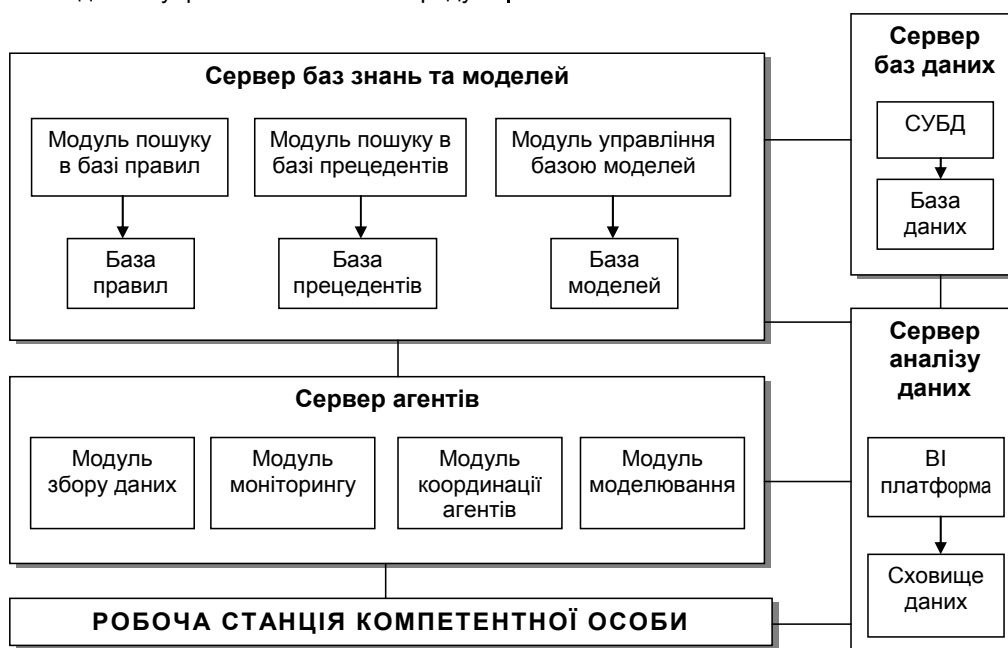
Рис. 3. Розміщення компонент AODSS в апаратно-програмному комплексі
