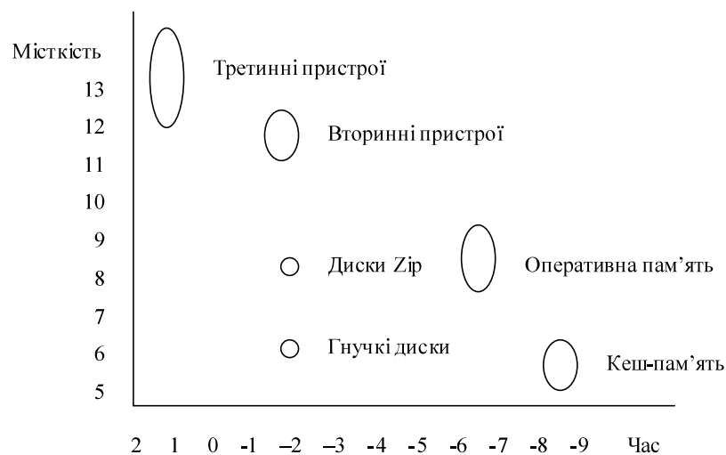
Рис. 3. Залежність значень часу доступу до даних і місткості пристроїв, які належать різним рівням ієрархії пам'яті
