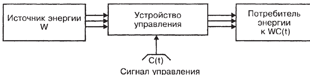
Рис. 1.1. Структурная схема усилительного устройства
