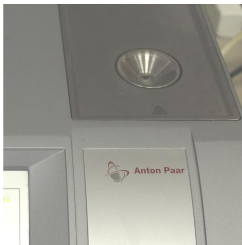
Рисунок 4.4.2 – Камера-гнездо для измерительной призмы и образца
