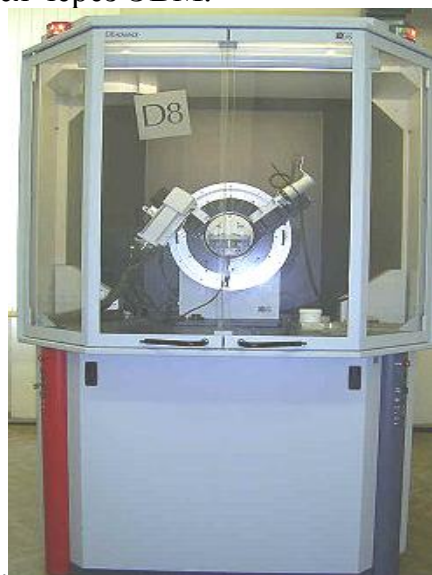
Рисунок 3.6.4 – Общий вид автоматического рентгеновского дифрактометра D8 Advance Bruker AXS (Германия)
