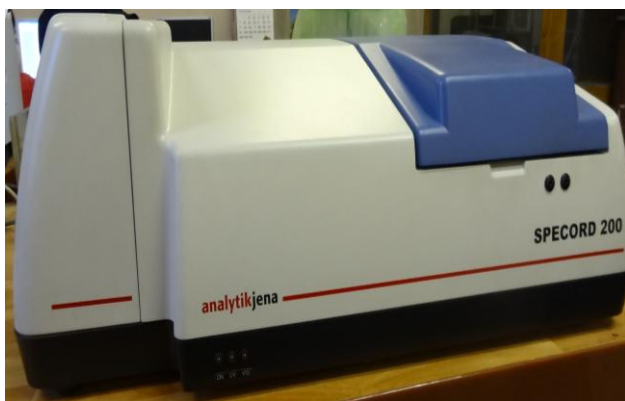
Рисунок 1.2.12 – а) – Общий вид спектрофотометра Specord M-200; б) – кюветное отделение спектрофотометра Specord M-200
