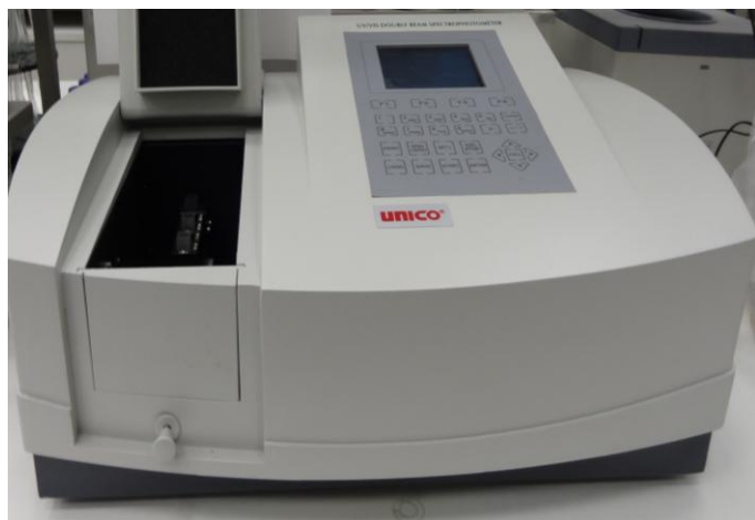
Рисунок 6.5.5 – Общий вид двухлучевого спектрофотометра Unicor–2804 ( \lambda = 190 - 1100 нм)
