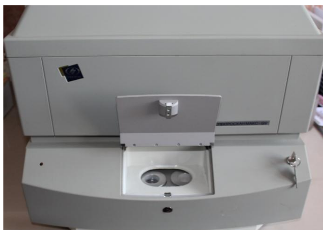
Рисунок 3.6.7 – Пробозагрузочное устройство спектрометра
