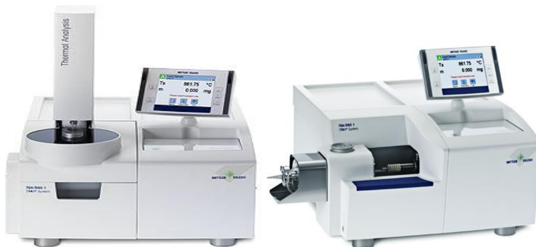
Рисунок 5.3.2 – Общий вид термогравиметрических анализаторов (дериватографов) фирмы МЕТТЛЕР ТОЛЕДО с вертикально (а) и горизонтально (б) расположенной печью
