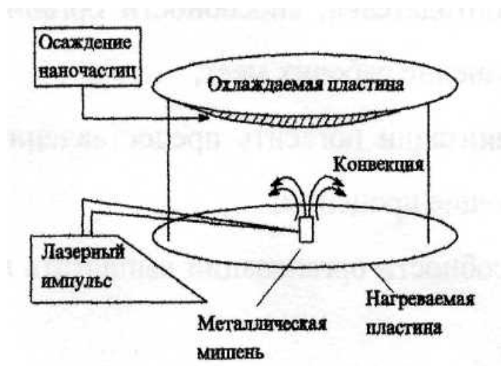
Рис. 19. Схема установки синтеза наночастиц методом лазерного испарения металлов.
