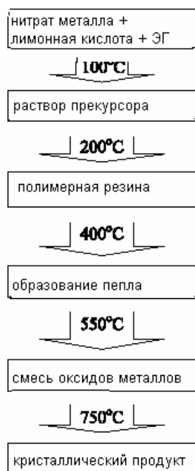
Рис. 13. Схема синтеза нанокристаллического продукта методом пиролиза полимера.
