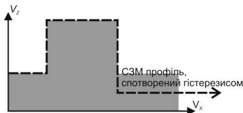
Рис. 7.6. Вплив гістерезису на отриманий профіль сходинки.
