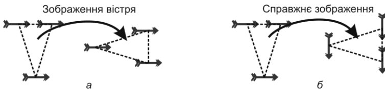
Рис. 7.27. Схема, що ілюструє простий тест на зондову згортку (поворот зразка на 90^\circ ): а – зондова згортка наявна; б – зондової згортки нема.
