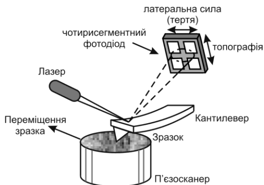
Рис. 7.20. Схема детектування відхилення кантилевера АСМ.
