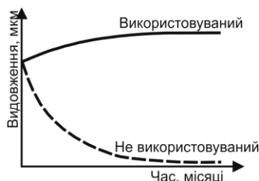
Рис. 7.9. Старіння сканера з часом (наведене максимальне видовження).
