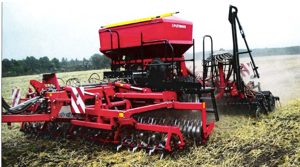
Рис. 2. Посівний комплекс "Terrasem"- 6000L. Агрегатуюється з трактором 250-320 к.с. За один прохід виконує: 1) подрібнення рослинних рештків і обробіток ґрунту; 2) вирівнювання поля котком; 3) рівномірний і точний посів; 4) прикочування посівів котками і легке розпушування борінками прикоченої поверхності. Виробіток за зміну – 36- 54 га. Витрати пального – 7 л/га. Вартість – 93 тис. євро на заводі.
