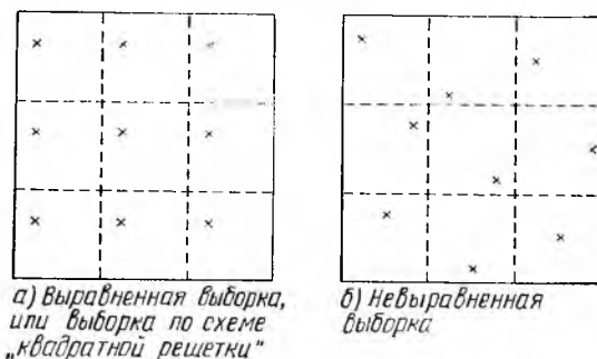
Рис. 8.4. Два типа двумерной систематической выборки
