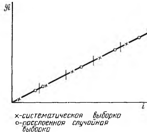
Рис. 8.2. Систематический отбор из совокупности с линейным трендом
