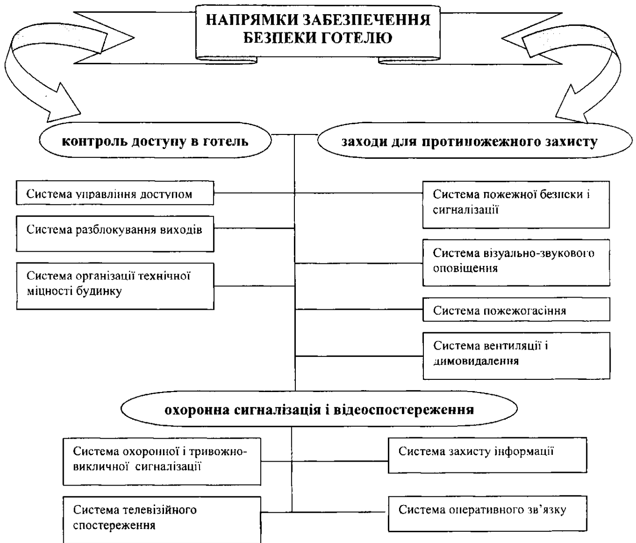
Рис. 16 – Основні підсистеми комплексу технічних засобів безпеки й засоби їхньої інтеграції в єдину систему безпеки готелю
