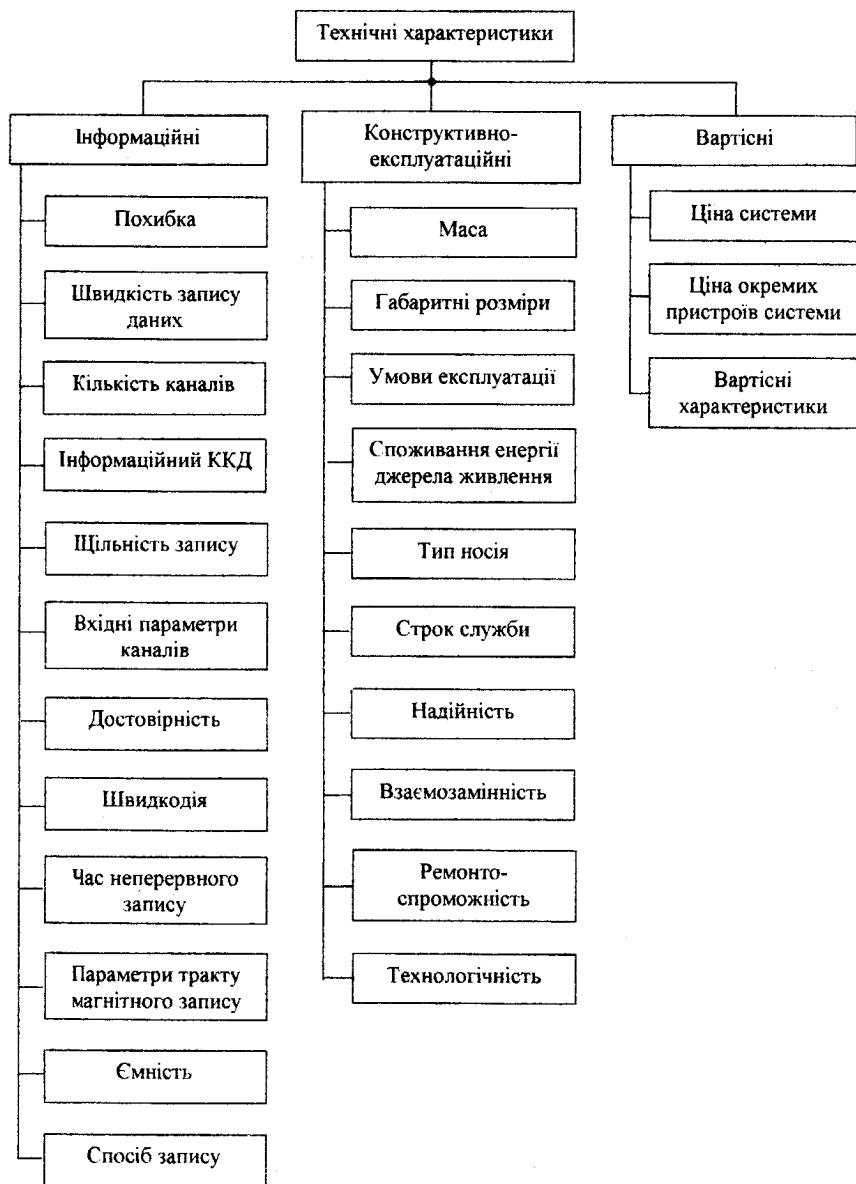
Рис. 2.1.4. Технічні характеристики АМЦСР
