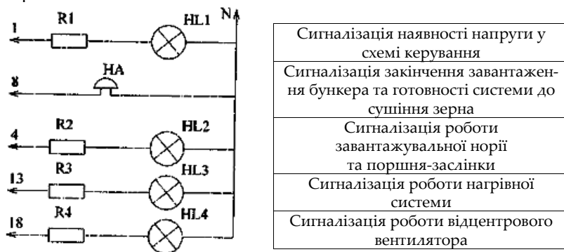
Рис: 4.17. Принципова електрична схема системи автоматичного контролю і роботи БВ-25
