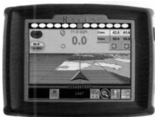
Рис. 4.27. Автоматичне управління секціями штанг АссуВом™:
