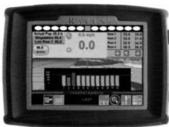
Рис. 4.26. Удосконалена система управління сівалкою Raven OmniROV™:
