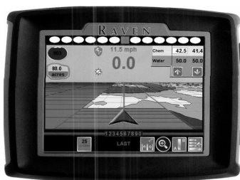
Рис. 4.25. Багатофункціональна навігаційна система Envizio Pro II
