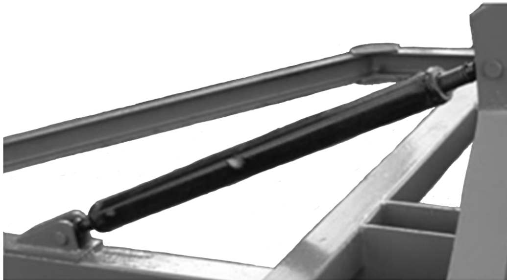
Рис. 9. Гвинтова телескопічна тяга
