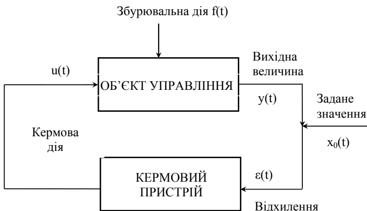
Рис. 4.1. Схематичне зображення автоматичної системи управління
