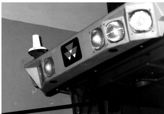
Рис. 5.12. Установка приймальної антени ДГСП-сигнала на зернозбиральному комбайні MF-38
