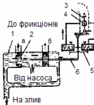
Рис. 4.21. Схема пристосування для водіння трактора за копіром:
