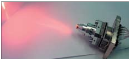
Рис. 12. Полупроводниковый лазер, установленный на термоэлектрическую охлаждающую сборку
