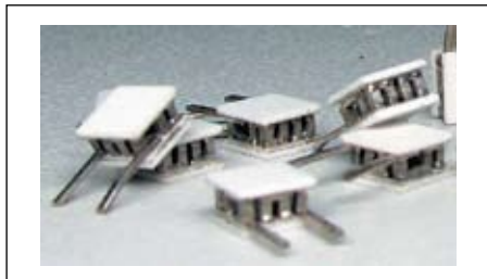
Рис. 6. Микромодули для охлаждения ИК-датчиков
