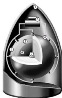
Рис. 1. 2D-зображення схеми ядерної боєголовки (1 — корпус; 2 — вибуховий механізм; 3 — вибухова речовина; 4 — електродетонатор; 5 — нейтронний відбивач; 6 — ядерне пальне ( ^{235}\text{U} ); 7 — джерело нейтронів; 8 — процес стиснення ядерного пального напрямленим всередину вибухом)
