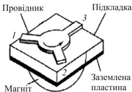
Рис. 8.12. Мікросмужковий Y-циркулятор
