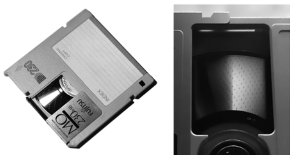
Рис. 7.11. Загальний вигляд магнітооптичного диска розміром 90 мм і видимі оптичні мітки на поверхні магнітооптичного носія
