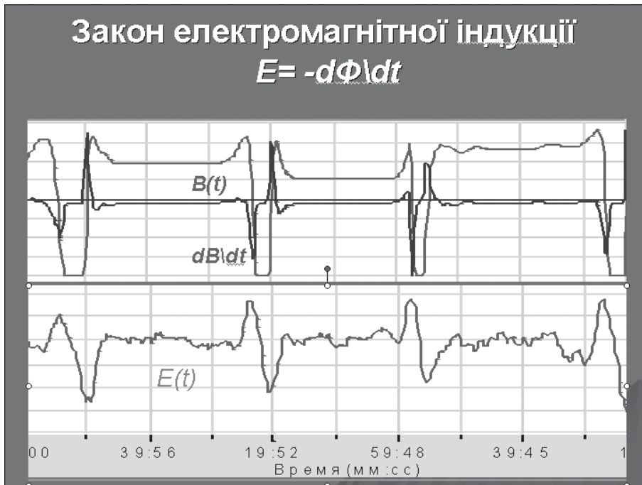
Рис. 2.6. Презентація осцилографічного вимірювання фізичного процесу
