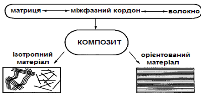
Рис. 5.38. Композиційні матеріали – ізотропний і орієнтований – та їх характерні властивості при різних наповнювачах: склі, вуглецю, арамідноволокном тощо
