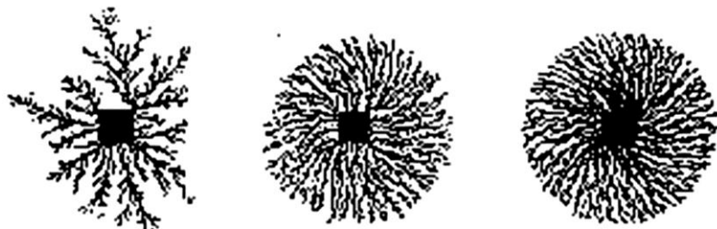
Рис. 2.11. Двовимірні срібні зразки отримані в магнітному полі прикладеному вертикально по відношенню до площини росту: зліва у відсутності магнітного поля; у центрі магнітне поле 4 Тл; справа магнітне поле 8 Тл. У кожному випадку час експерименту складав 150 хв.
