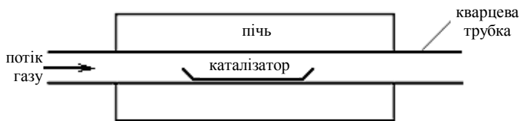
Рис. 5.4. Схема установки для одержання нанотрубок методом хімічного осадження.
