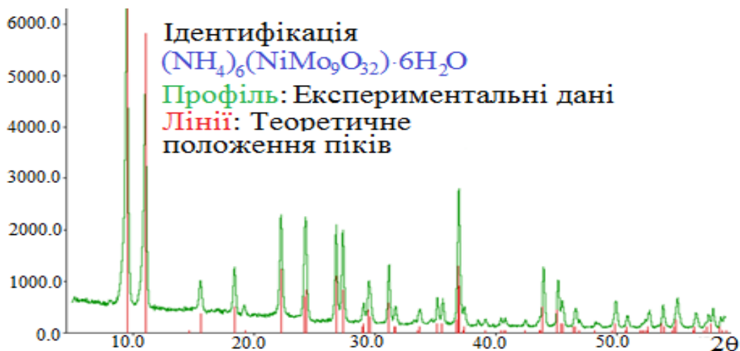
Рис. 2.30. Рентгенограма (\text{NH}_4)_6(\text{NiMo}_9\text{O}_{32}) \cdot 6\text{H}_2\text{O}
