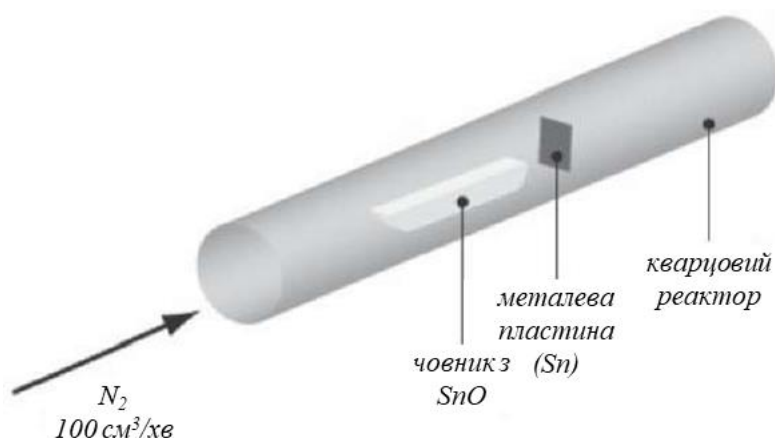
Рис. 3. Лабораторна установка для одержання ниткоподібних кристалів станум (IV) оксиду
