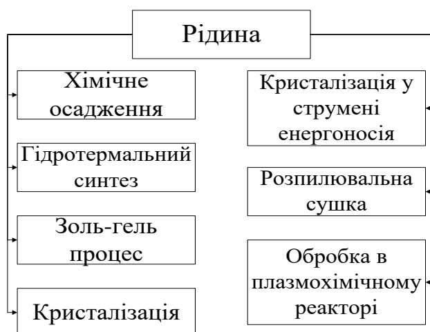
Рис. 2.6. Методи отримання функціональних матеріалів із рідкої фази
