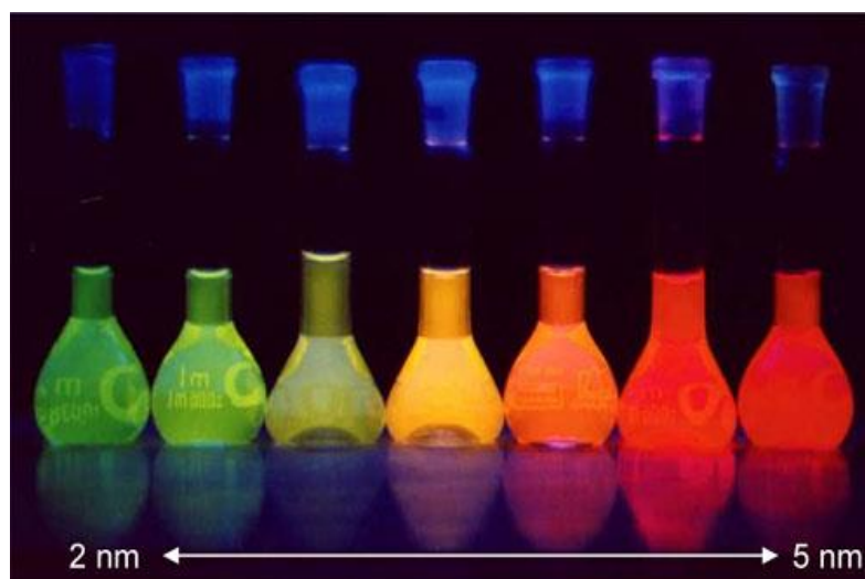
Рис. 4.18. Флуоресценція суспензій колоїдних частинок CdTe різного розміру [34]: зліва направо від 2 до 5 нм
