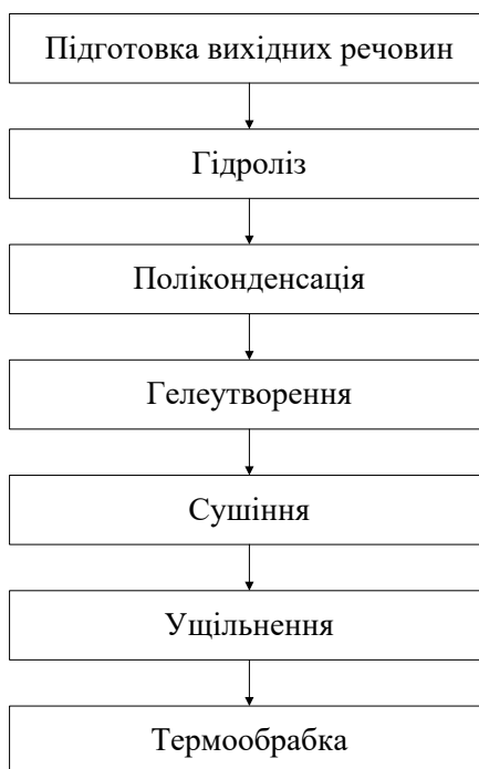
Рис. 2.11. Принципова схема золь-гель методу
