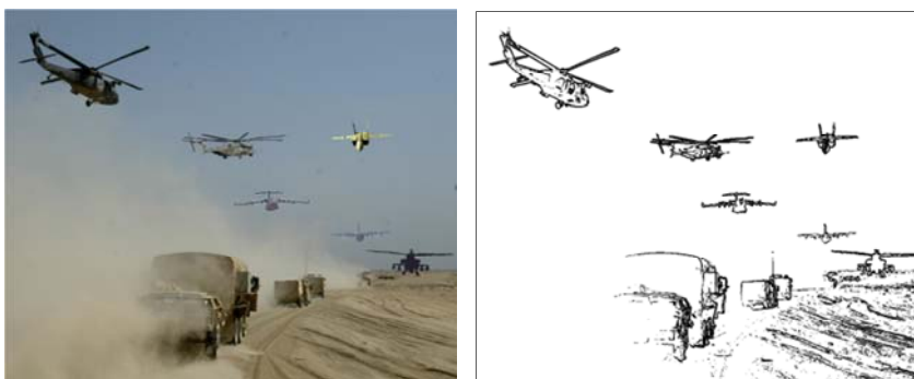
Рис. 12.3. Пример выполнения бинаризации: a – исходное мультиспектральное изображение; b – бинарное изображение, полученное из a вышеописанным методом
