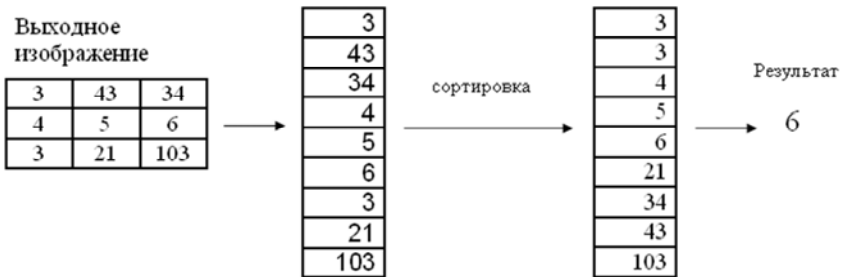
Рис. 10.12. Идея медианной фильтрации в окне 3 \times 3
