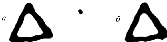
Рис. 14.10. Изображение 14.9 после медианной фильтрации: б – с морфологической фильтрацией, а – без
