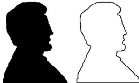
Рис. 11.10. Пример морфологического выделения границы
