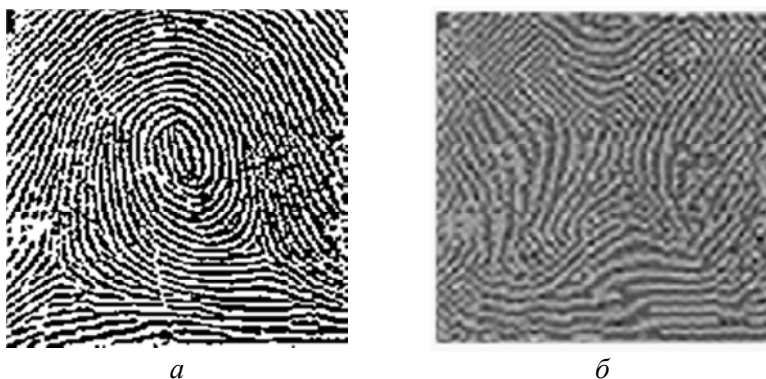
Рис. 2.1. Влияние интервала дискретизации на представление изображения отпечатка пальца
