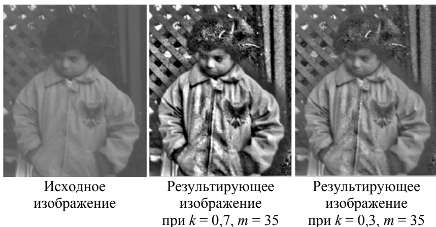
Рис. 9.21. Результаты обработки исходного изображения, полученные с использованием формулы (9.4); m – размер локального окна
