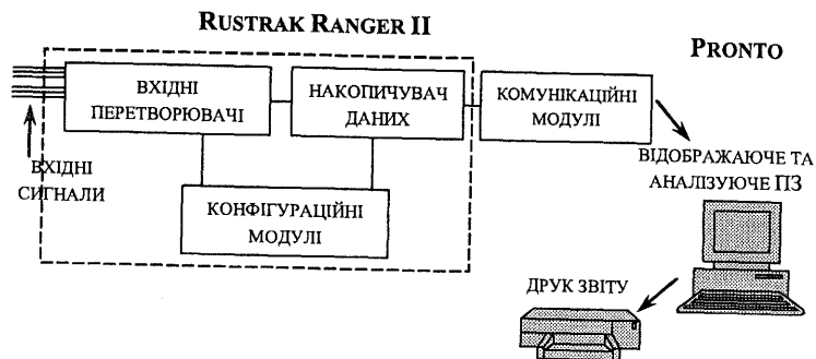
Рис. 11.6. Блок-схема комплексу Rustrak Ranger II.
