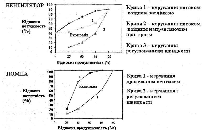
Рис. 5.2. Залежність споживання потужності приводу для різних методів керування від продуктивності вентилятора та помпи
