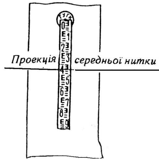
Рис. 100. Прив'язка до стінних реперів, які розташовані вище горизонту приладу
