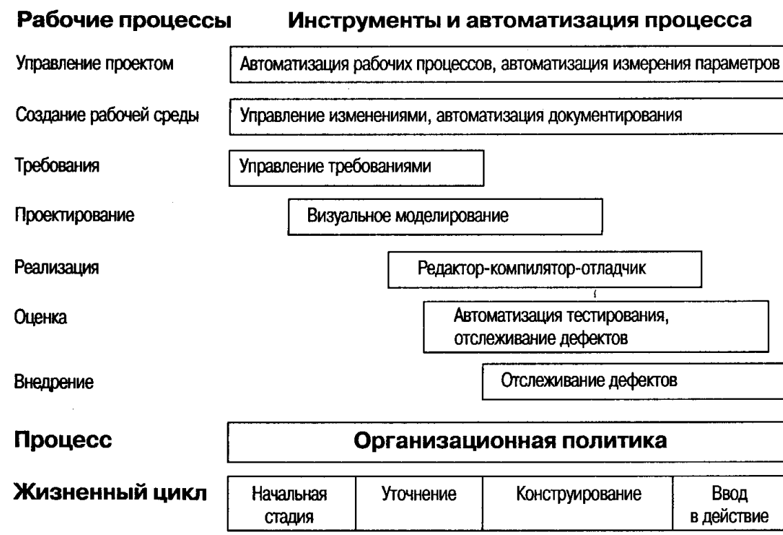
Рис. 12.1. Типичные компоненты автоматизации и инструменты, которые поддерживают различные рабочие процессы
