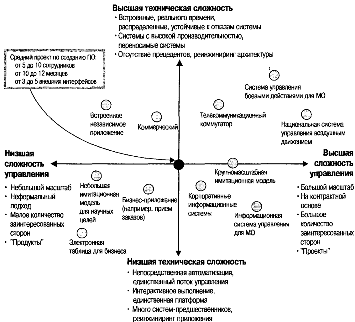
Рис. 14.1. Два главных измерения изменчивости процесса
