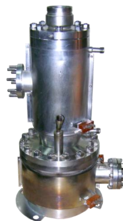
в) орбітронний надвисоковакуумний насос
