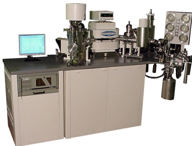
Рис. 8. Мас-спектрометр MI 1201 АГМ 01М (ВАТ «Selmi» 2010 р.) з безмасляною вакуумною системою попереднього відкачування
