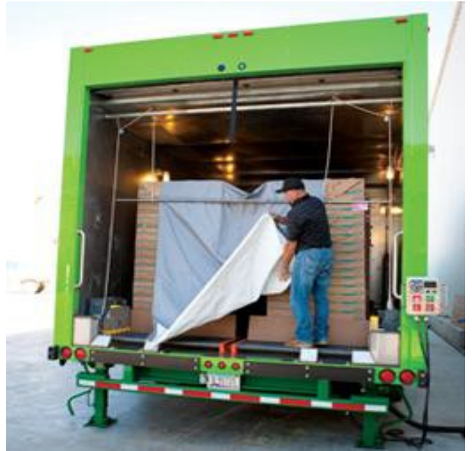
Малюнок 6. Напірне охолодження свіжо зірваної продукції
