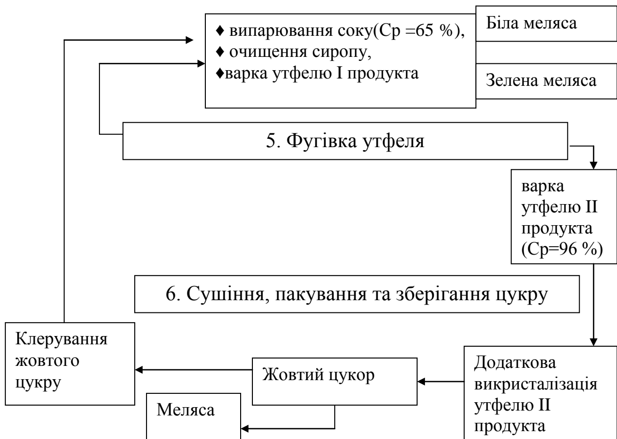
Рис. 57. Технологічна схема виробництва цукру
