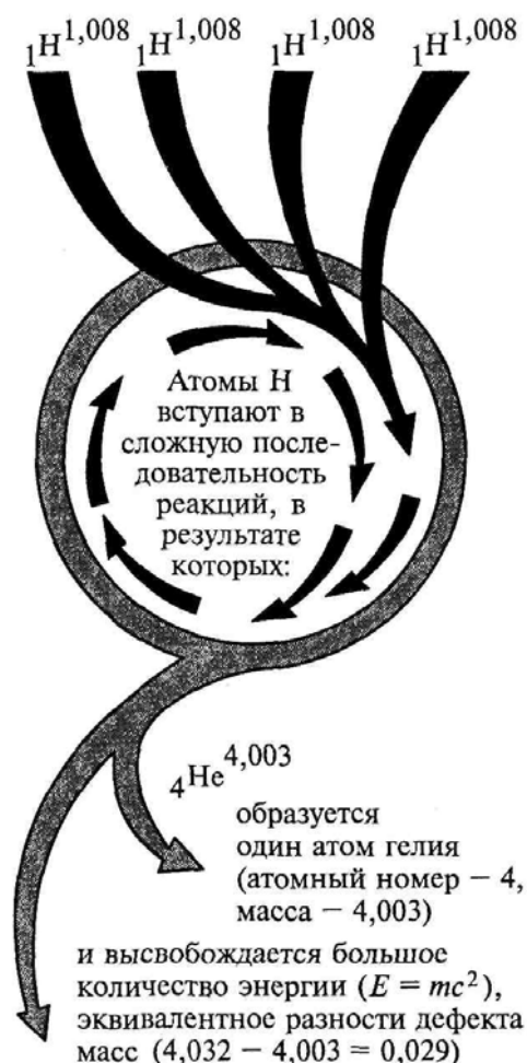
Рис. 9.2. Схема синтеза гелия из атомов водорода
