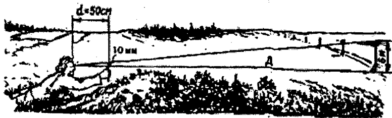
Рис. 4.7. Визначення відстаней за лінійними розмірами предметів.
