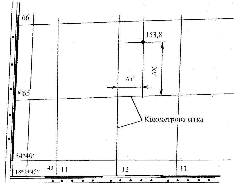
Рис. 7.4. Визначення прямокутних координат точки
