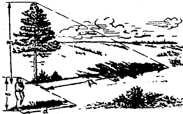
Рис. 4.9. Визначення висоти предмета за його тінню.
