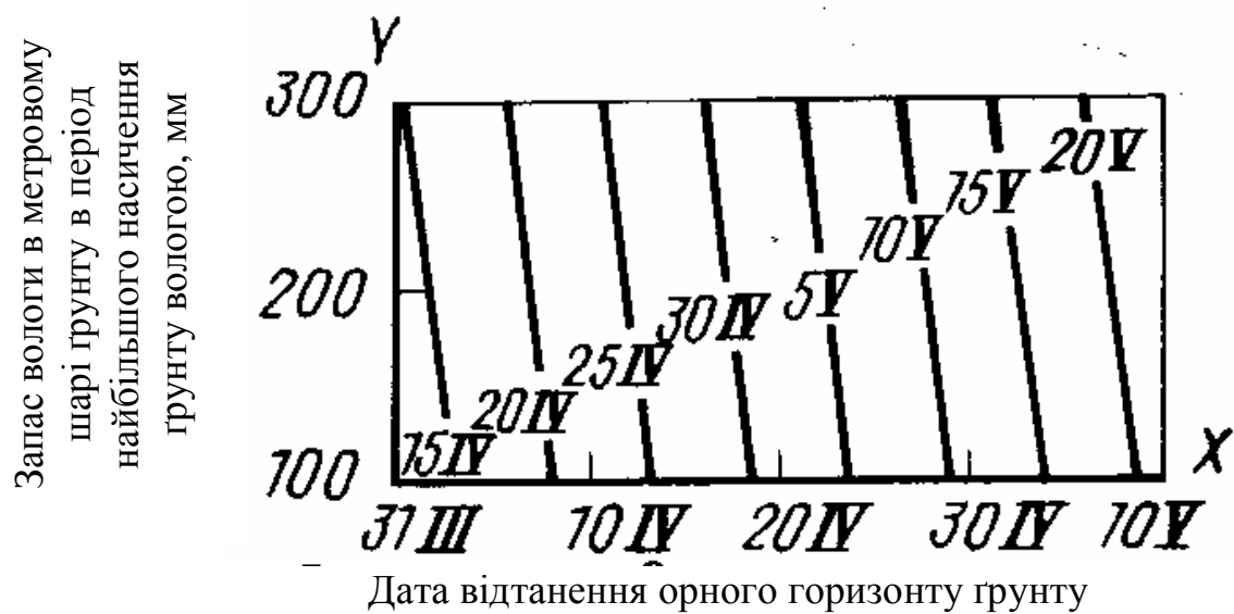
Рис.9.3 – Графік для розрахунку дати просихання ґрунту до м'якопластичного стану
