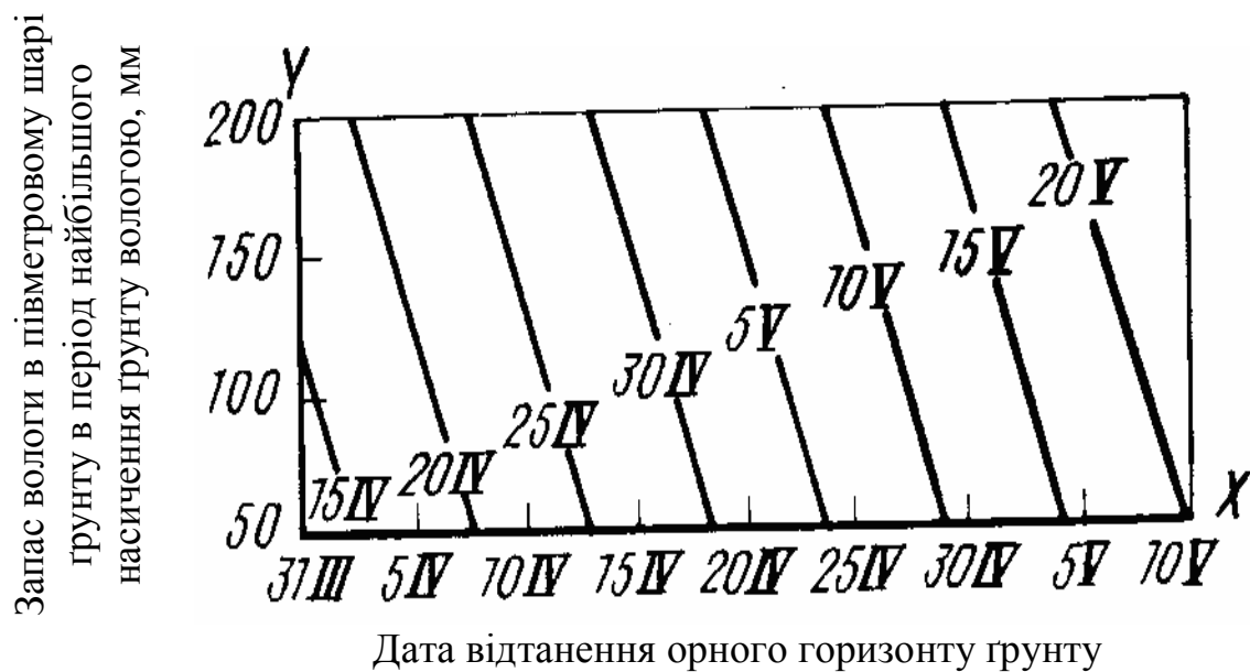
Рис. 9.4 – Графік для розрахунку дати просихання орного шару ґрунту до м'якопластичного стану для супіщаних ґрунтів
