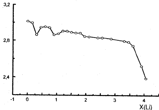
Рис. 3.23. Функціональна залежність зміни енергії Гіббса реакції інтеркаляції іонів літію в ССМ
