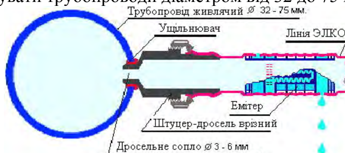
Рис. 2.8. Схема підключення за допомогою штуцера-дроселя.
