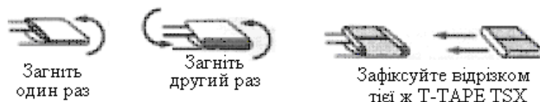
Рис. 5.3. Схема закриття кінців поливних трубок.
