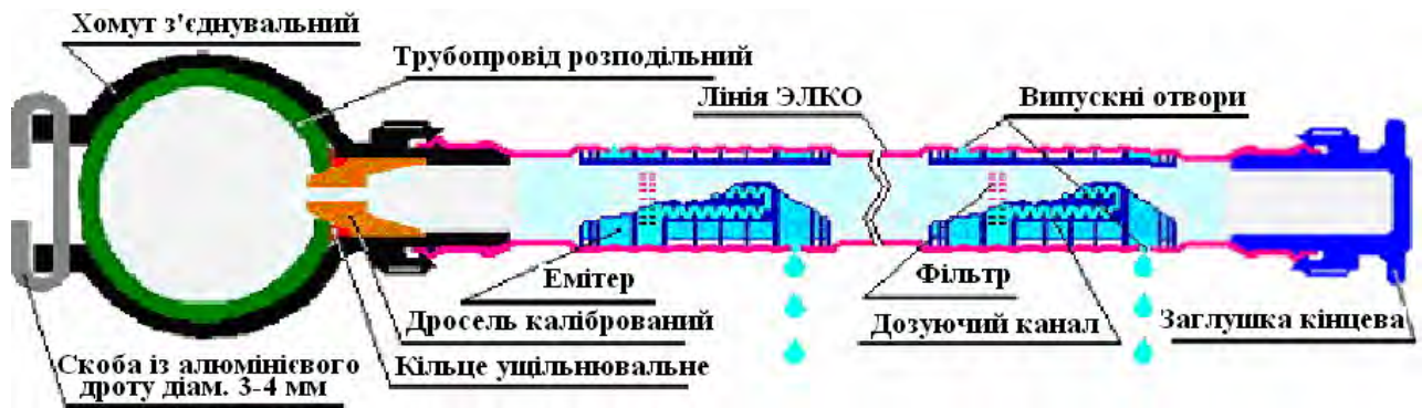
Рис. 2.7. Схема роботи емітерної лінії ЕЛКО
