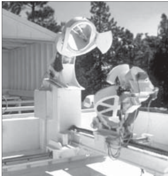
Рис. 9.8. Целостат сонячного телескопа
