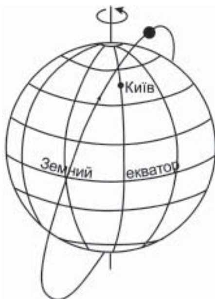
Рис. 7.3. Схема орбіти штучного супутника Землі, запущеного під кутом i = 65^\circ до площини земного екватора
