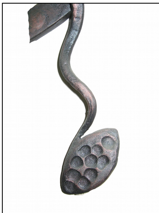
Фото 16. Вивчення основних ковальських прийомів Study of basic blacksmith's receptions (Витягування, закручування, нанесення фактури, зварювання)
