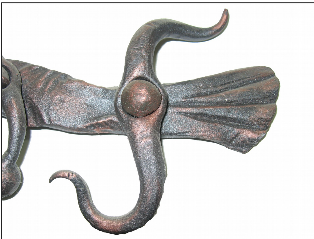
Фото 5. Вивчення основних ковальських прийомів Study of basic blacksmith's receptions (Витягування, насікання, загострювання, заклепування)
