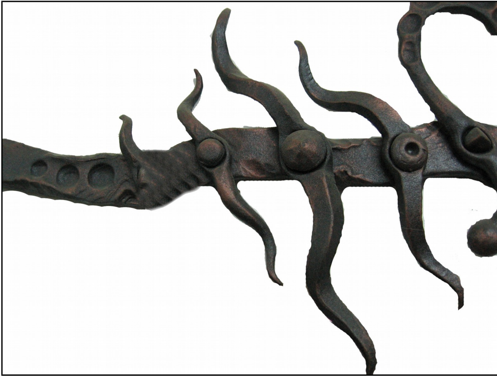
Фото 7. Вивчення основних ковальських прийомів Study of basic blacksmith's receptions (Витягування, насікання, загострювання, заклепування)
