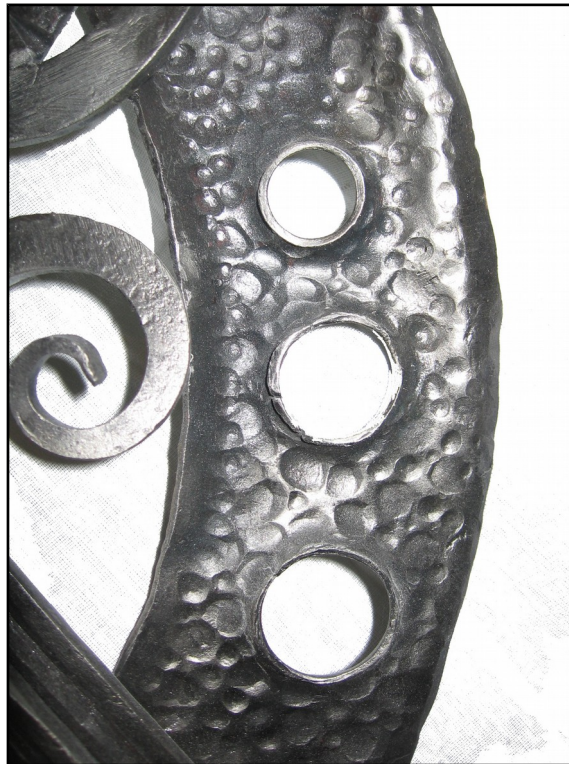
Фото 14. Вивчення основних ковальських прийомів Study of basic blacksmith's receptions (Прошивання отворів, нанесення фактури)
