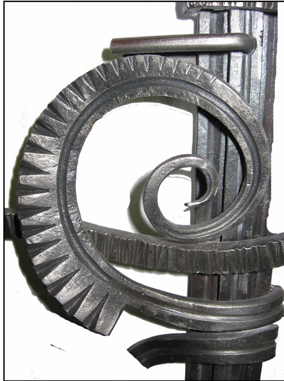
Фото 3. Вивчення основних ковальських прийомів Study of basic blacksmith's receptions (Витягування, загострення, насікання, закручування)
