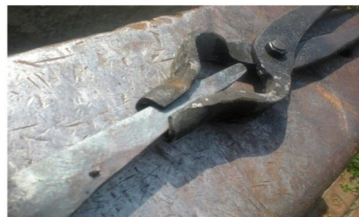
Рис. Г.4. Приклад 4. Поетапність виготовлення кліщів з квадратними губкам
