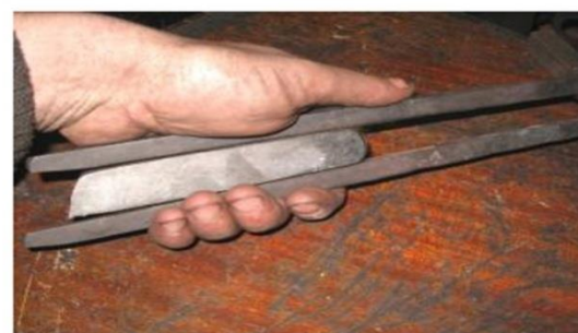
Рис. Г.3. Приклад 3. Поетапність виготовлення кліщів з квадратними губками
