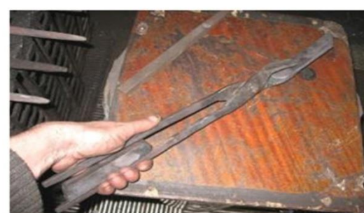
Рис. Г.3. Приклад 3. Поетапність виготовлення кліщів з квадратними губками
