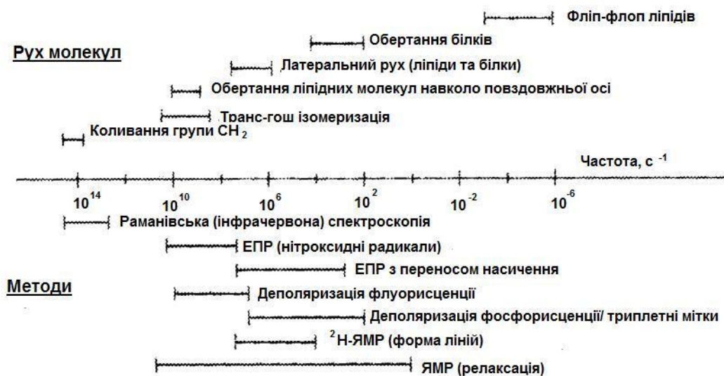
Рис. 5.2. Порівняння характерних частот рухів мембранних білків і ліпідів з діапазоном чутливості різних спектроскопічних методів. Діапазон чутливості методів вказаний приблизно.
