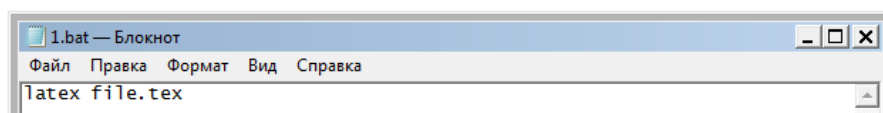
Рис.1. Приклад створення файлу 1.bat для компіляції документу file.tex та отримання готового до перегляду файлу file.dvi .
