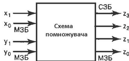
Рис. 2.8. Схема помножувача до завдання 4.
