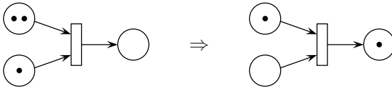
Рис. 15. Графічне зображення спрацювання переходу
