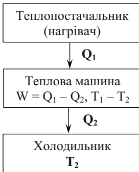
Рис. 2. Схема переходу теплоти в роботу у тепловому двигуні
