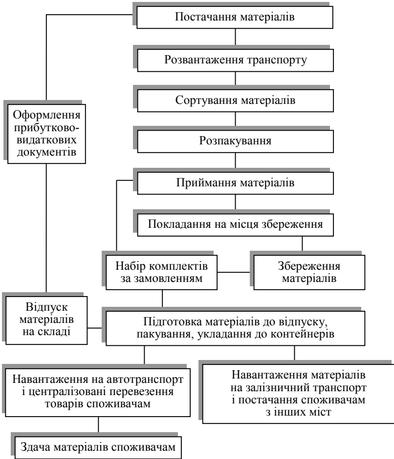
Рис. 15. Схема технологічного процесу роботи складу
