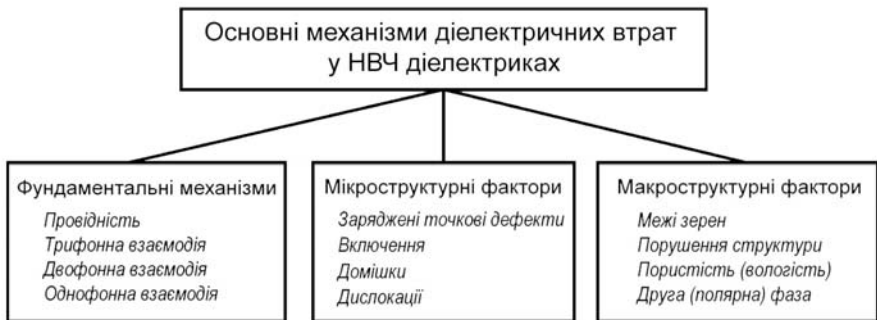
Рис 10.5. Основні механізми діелектричних втрат у діелектриках, призначених для діапазону НВЧ
