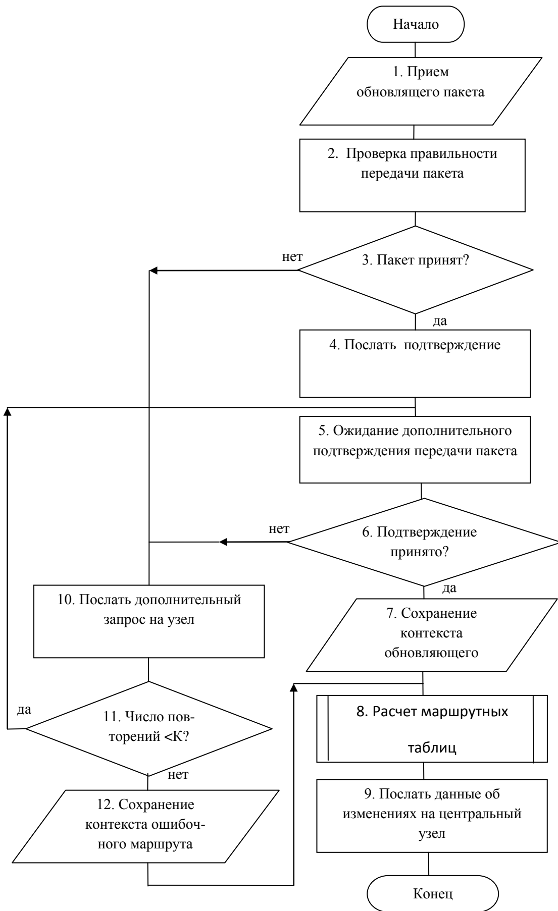
Рис. 8.4. Структурная схема алгоритма изменения маршрутной информации по данным промежуточных узлов сети
