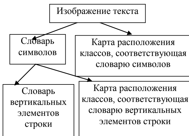
Рис. 27.7. Схема двухэтапной обработки изображения текста алгоритмом ИЛЛ2
