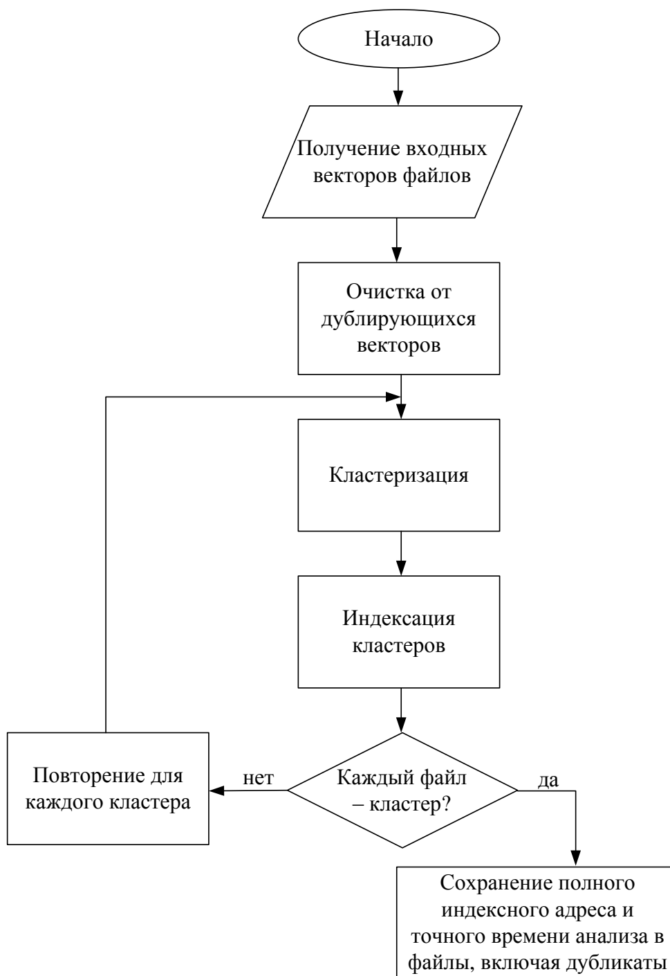
Рис. 10.2. Схема работы модуля «Обработчик»
