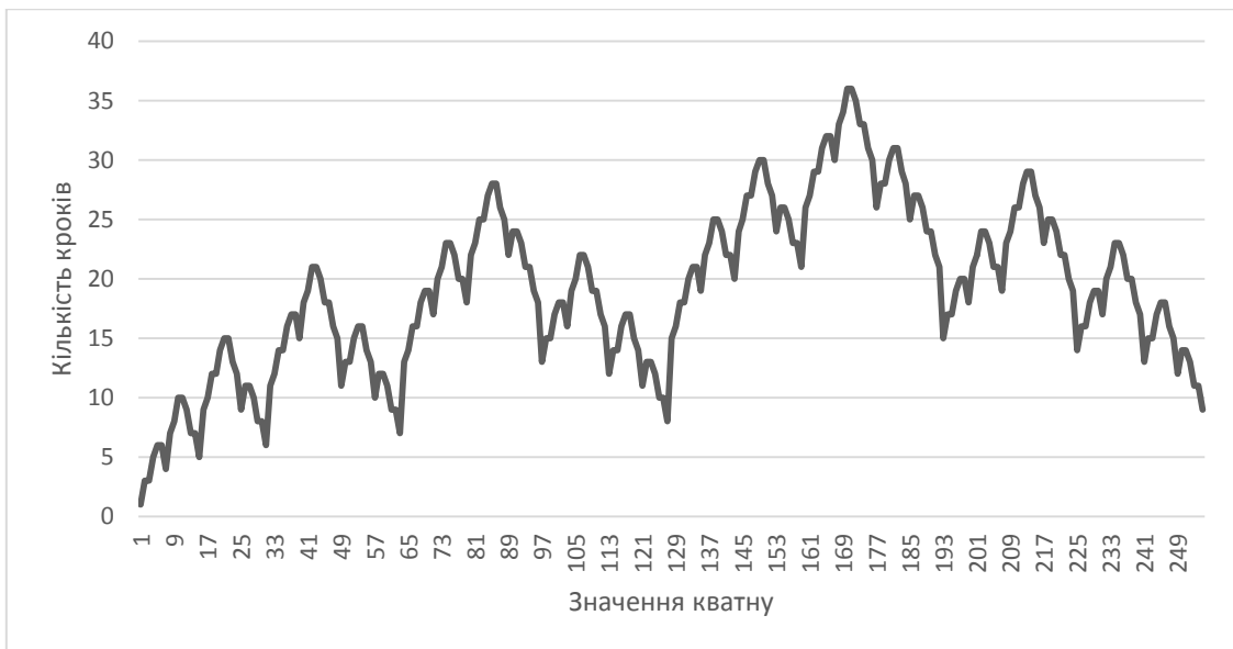
Рис. 18.2. Залежність кількості кроків перетворення в функції кількості квантів
