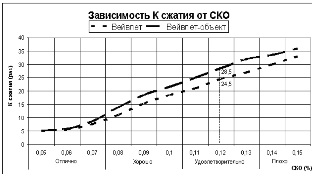
Рис. 5.9. Зависимость коэффициента сжатия ( K_{сж} ) от среднеквадратической ошибки (СКО) при вейвлет анализе изображения
