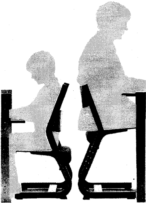
Рис. 6.18. Взаєморозміщення основних елементів робочого місця при виконанні робіт у положенні сидячи (а, б).
