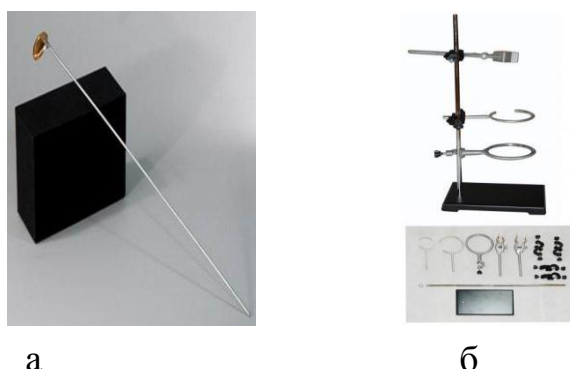
Рис. 36: а - металева ложечка для спалювання речовин; б - металевий штатив з затискачами та кільцями
