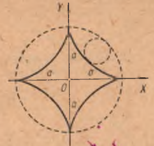
27. Гипоциклоида (астроида) \begin{cases} x = a \cos^3 t, \\ y = a \sin^3 t \end{cases} или x^2/3 + y^2/3 = a^2/3.
