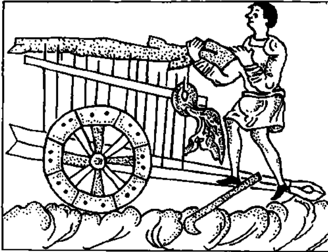
Саксонская повозка. С миниатюры XI в. Колеса — со спицами и составным ободом
