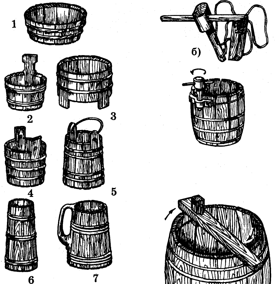
51. Бондарний посуд: а) 1 — цебрик; 2 — рязка (відро); 3 — цебер; 4 — цеберка; 5 — відро; 6 — маслоробка; 7 — кухоль для пива; б) — стягування обручів; в) прорізання уторної канавки для дна.
